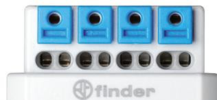
Terminali sdoppiati facilitano il collegamento di ponticelli o il collegamento di altri prodotti in parallelo. Ogni morsetto può ospitare un cavo di sezione 2.5 mm<sup>2</sup>.
